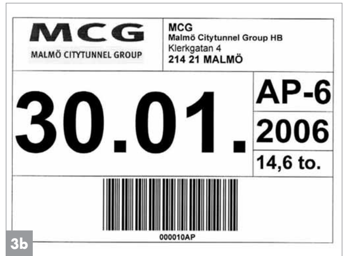
Barcode-Etiketten, die nach dem Ausschalen auf die Betonfertigteile aufgeklebt werden
