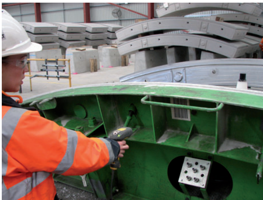
Abb. 6: Ablesung der Barcodes mit einem Barcodelesegerät
