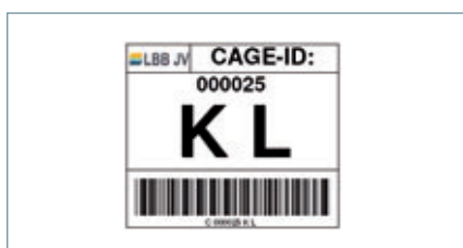
Abb. 4: Jedem Bewehrungskorb wird ein eindeutiger Barcode zugeordnet.
