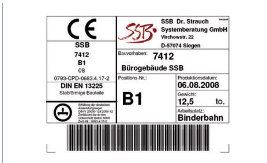
Abb. 13: CE-konforme Etikettierung von Fertigteilen
