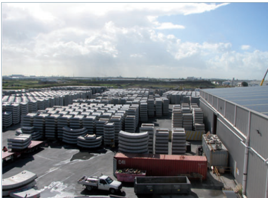
Abb. 10: Im Lager liegen insgesamt durchschnittlich 10.000 Elemente aller neun Grundtypen. Die Grundtypen K-B-C-A1-A2-A3-A4-A5-A6 bilden jeweils einen kompletten Ring, wobei durch die Lage im Tunnel (L/R) sowie die Art der Bewehrung eine weitere Differenzierung definiert wird.
